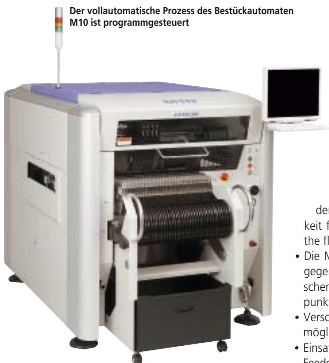
Die Feederintelligenz ist seit Jahren bewährt und wird nun durch die Verwendung vollelektrischer Feeder ergänzt, die frei programmierbar sind. Insofern ist nur noch ein Feeder für unterschiedliche Taschenabstände bei 8-mm-Gurten notwendig. Viele Softwarehilfsmittel, wie das seit Jahren geschätzte ADA und die neue automatische Bauteiltaschenkorrektur, erleichtern die Arbeit mit der komplexen Technologie der SMT.
